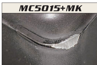
Desgaste de 0,44 mm tras mecanizar 17 pzas.
