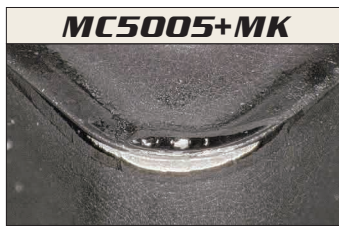
Desgaste de 0,29 mm tras mecanizar 30 pzas.
